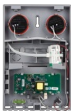
JA-163A-BASE-RB - bottendelen med elektronik
