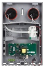
JA-163A-BASE-RB - spodný plast s elektronikou
