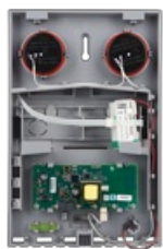
JA-163A-BASE-RB - Dolna część z elektroniką
