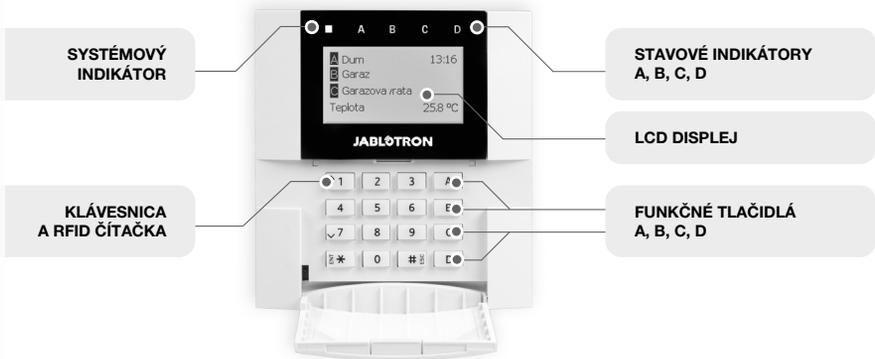
Stav jednotlivých sekcií je indikovaný stavovými indikátormi A, B, C, D nad LCD displejom a funkčnými tlačidlami. Vlastné ovládanie (vypnutie alebo zapnutie ochrany v systéme a ďalšie funkcie automatizácie) sa robia pomocou funkčných tlačidiel. Funkčné tlačidlá na ovládanie sekcií a stavové indikátory (A, B, C, D) sú farebne podsvietené tak, aby bol na prvý pohľad zreteľne indikovaný stav sekcií.
