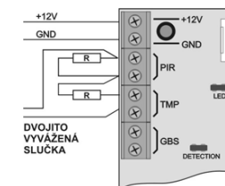
Príklad zapojenia detektora JS-20 LARGO do dvojito vyváženej slučky pre iné ústredne.
