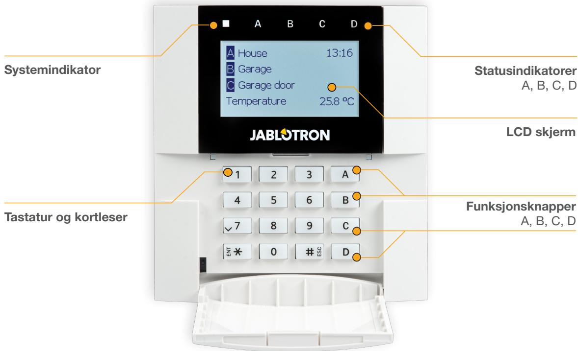
Status for enkeltområder indikeres ved hjelp av statusindikatorene A, B, C, D over LCD-displayet og med funksjonstastene. Alarmsentralen kan betjenes direkte (ved å tilkoble eller frakoble alarm og andre automatiseringsfunksjoner), med brukerfunksjonssegmenter på panelet. Funksjonstastene og statusindikatorene A, B, C, D er utstyrt med fargerik baklys for å tydelig vise områdets status.
