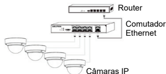
Fig. 2: Esquema de ligação do comutador Ethernet
