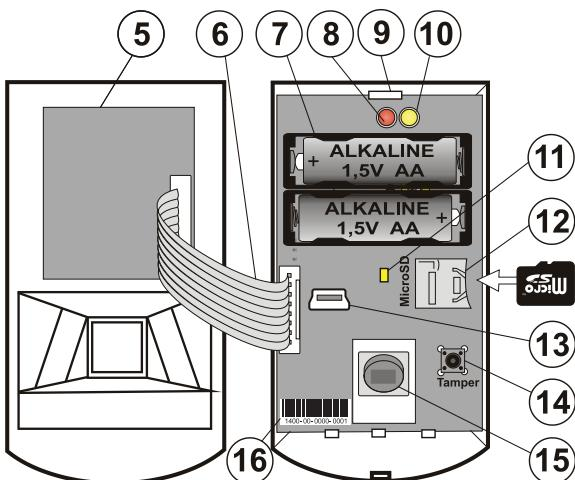
Figur: 5 – Kameramodul; 6 – tilslutningskabel; 7 – batterier; 8 – rød LED-indikator; 9 – Printets tap; 10 – Gul LED-indikator; 11 – Gul LED Mikro SD kortindikator; 12 – Micro SD hukommelseskort; 13 – mini USB-stik; 14 – sabotagekontakt; 15 – PIR-sensor; 16 – serienummer.
