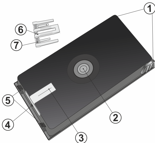
Obr. 1: Tiesňové tlačidlo umiestnené na montážnej podložke: 1. držiak pántov, 2. tlačidlo A, 3. spínač B, 4. aretačná skrutka horného krytu, 5. aretačné západky spodného dielu podložky, 6. výmenná spona pre bankovku, 7. svetlovod pre LED kontrolku
