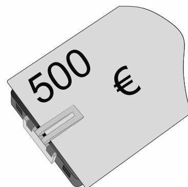
Рис. 2: тревожная кнопка, оснащенная держателем для банкнот
