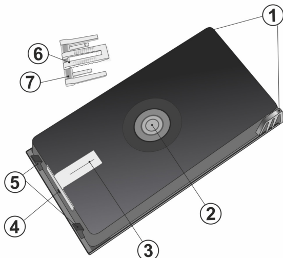
Fig. 1: botão de pânico na respetiva plataforma de montagem: 1. Dobradiças, 2. Botão A, 3. Interruptor B, 4. Parafuso de fixação da placa traseira, 5. Patilhas da plataforma de montagem, 6. Clipe substituível para nota bancária ou documento, 7. Guia com indicador de LED.
