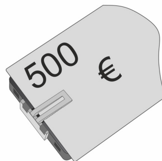
Fig. 2: botão de pânico equipado com suporte para nota bancária
