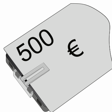
Rys. 2: Przycisk alarmu paniki wyposażony w uchwyt na banknoty
