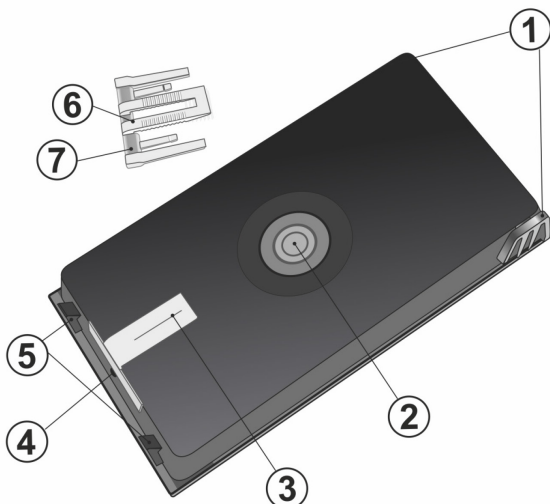
Fig. 1: Panikknapp i sin monteringsplattform: 1. Hengsler, 2. Knapp A, 3. Bryter B, 4. Skruer for festing til bakplate, 5. Monteringsplattformlåser, 6. Utskiftbar pengeseddel- eller dokumentklips, 7. LED-lysleder.
