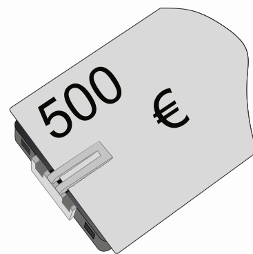
Fig. 2: pulsante panico dotato di un porta banconote
