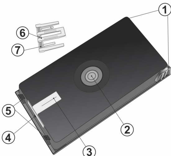
Fig. 1: Il pulsante anti-panico si trova nella propria piattaforma di montaggio: 1. Cardini, 2. Pulsante A, 3. Interruttore B, 4. Vite di fissaggio piastra posteriore, 5. Fermi della piattaforma di montaggio, 6. Clip sostituibile per banconote o documenti, 7. Guida luce LED.
