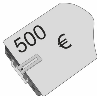
2. ábra: A pénzjegycsapdával kiegészített pánik nyomógomb
