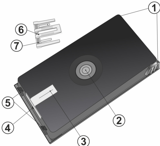
Kuva 1: Paniikkipainike asennusalueella: 1. Saranapisteet, 2. Painike A, 3. Setelilytkin B, 4. Takalevyn lukitusruuvi, 5. Asennusalan kiinnikkeet, 6. Vaihdeasettelin tai dokumenttipidike, 7. Ledvalojohto.
