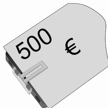
Fig. 2: botón de pánico equipado con un soporte para billetes
