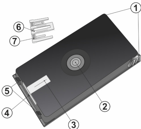
Fig. 1: Botón de pánico en su plataforma de montaje: 1. Bisagras;
