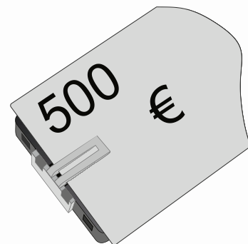
Abb. 2: Mit einer Halterung für Banknoten ausgerüsteter Panikknopf
