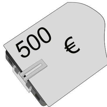
Fig. 2: Panikknop udstyret med en seddelholder
