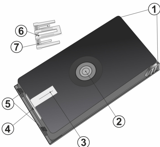
Billede 1: Panikalarmknap i monteringsplade: 1. Hængsler, 2. Knap A, 3. Kontakt B, 4. Fastgørelsesskrue til bagplade, 5. Låsetapper på monteringsplade, 6. Udskiftelig pengeclips eller dokumentholder, 7. LED lysindikering.
