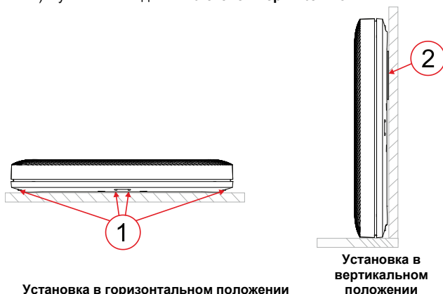
Рисунок 1: Типы установки и описание внешних частей изделия 1 – штифты обнаружения; 2 – магнитная наклейка
