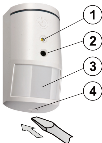
Figur: 1 – blixtpålysning 2 – kamerallins; 3 – PIR detektor-lins; 4 – kåpens flik
