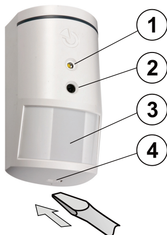
Slika: 1 – foto fleš za svetljenje; 2 – objektiv kamere; 3 – leča PIR detektorja; 4 - zapah pokrova;
