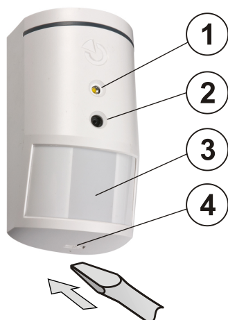
Рисунок: 1 - вспышка для подсветки; 2 - объектив камеры; 3 - объектив PIR-детектора; 4 - язычок крышки
