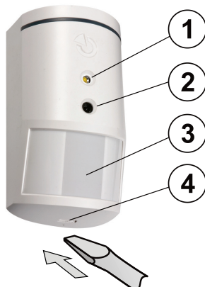
Figura: 1 - flash para iluminação; 2 - lente da câmara; 3 - lente do detetor PIR; 4 - patilha da tampa
