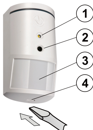
Rysunek: 1 – flesz do oświetlania; 2 – obiektyw kamery 3 – Sensor PIR; 4 – Zatrzask obudowy;
