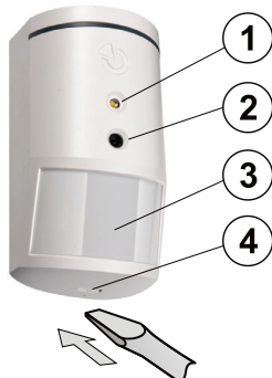
1. ábra: 1 – villanófény; 2 – a fényképezőgép objektívje; 3 – a PIR mozgásérzékelő lencséje; 4 – az érzékelő fedelének rögzítő nyelve;
