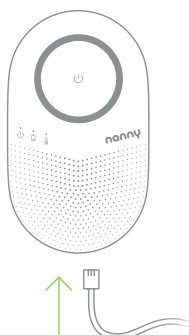
Obr. 9 Pripojenie prepojavacieho kábla k vyhodnocovacej jednotke
