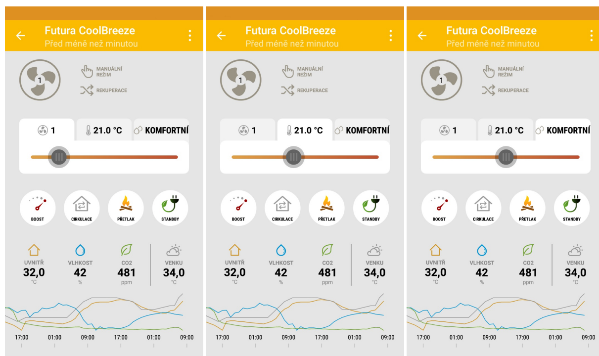
Obrázek 21 – Nastavení výkonu ventilátorů; Obrázek 22 – Nastavení teploty; Obrázek 23 – Nastavení vlhkosti
