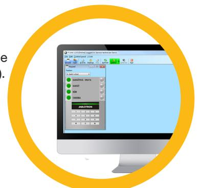
Es posible armar / desarmar el sistema utilizando los iconos de la parte inferior de la barra del programa o con los botones “Estado” en la pestaña “Partición”. Si se utiliza en el sistema un teclado con al menos un segmento de control, entonces será posible armar/desarmar el sistema desde JA-100-Link utilizando un teclado virtual (pulsar en “Teclado” en el menú principal).
