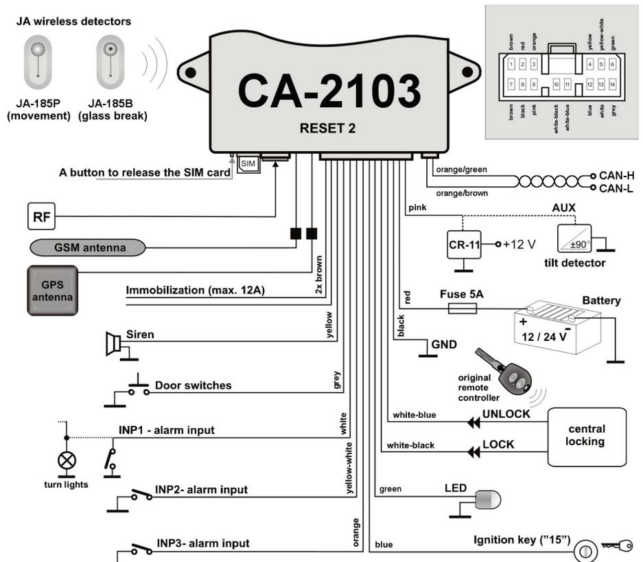
**Fig. 1: Conexión de la alarma de vehículos en el perfil RESET 2.** En esta conexión, la alarma se controla a través de los controles originales del vehículo.
