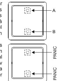
RC-22 kan dessutom användas som panikkontakt, i denna funktion sänds en speciell paniksignal oberoende av vilken del av vippbrytaren som trycks på. Denna funktion används när man t.ex. sänder paniklarm till centralenhet JA-60.
