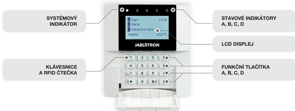
Stav jednotlivých sekcí je indikován stavovými indikátory A, B, C, D nad LCD displejem a funkčními tlačítky. Vlastní ovládání (odjistění nebo zajištění systému a další funkce automatizace) se provádí pomocí funkčních tlačítek. Funkční tlačítka sekcí a stavové indikátory (A, B, C, D) jsou barevně prosvětleny tak, aby byl na první pohled zřetelně indikován stav sekcí.
