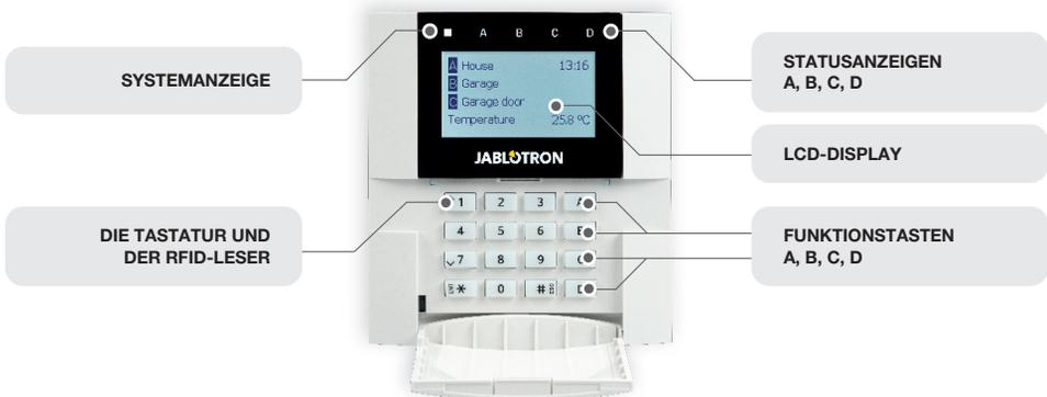
Der Status der einzelnen Bereiche wird durch die Statusanzeigen A, B, C, D über dem LCD-Display und durch die Funktionstasten angezeigt. Die Zentrale kann direkt gesteuert werden (Scharf- oder Unscharfschaltung des Alarms und andere Automatisierungsfunktionen), indem man die Funktionstasten auf der Tastatur verwendet. Die Funktionstasten und die Statusanzeigen A, B, C, D sind farbig hinterleuchtet, um den Bereichsstatus deutlich anzuzeigen.
