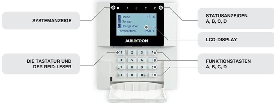
Der Status der einzelnen Bereiche wird durch die Statusanzeigen A, B, C, D über dem LCD-Display und durch die Funktionstasten angezeigt. Die Zentrale kann direkt gesteuert werden (Scharf- oder Unscharfschaltung des Alarms und andere Automatisierungsfunktionen), indem man die Funktionstasten auf der Tastatur verwendet. Die Funktionstasten und die Statusanzeigen A, B, C, D sind farbig hinterleuchtet, um den Bereichsstatus deutlich anzuzeigen.
