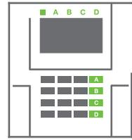
**1. Wenn Sie das Gebäude betreten** (und ein Melder mit einer Reaktion „Verzögerte Zone“ ausgelöst wird), beginnt das System die Eingangsverzögerung zu aktivieren und zeigt dies mit einem Dauerton an, wo eine Eingangsverzögerung ausgelöst wurde. Die Systemanzeige und eine Funktionstaste blinken rot.
