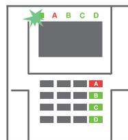
**3. Der Befehl wird ausgeführt** und die Tastatur zeigt akustisch die Ausgangsverzögerung an. Der Bereich ist jetzt scharf geschaltet. Nur Melder mit der Reaktion einer „Verzögerten Zone“ bieten Zeit zum Verlassen des überwachten Bereichs während der Ausgangsverzögerung. Die Statusanzeige und eine Funktionstaste des scharf geschalteten Bereichs werden rot.
