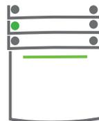
**1. Wenn Sie das Gebäude betreten** (Auslösung des Melders mit der Reaktion „Verzögerte Zone“), signalisiert das System die Eingangsverzögerung mit einem Dauerton und die Bereichstaste des Sicherungsbereiches, in dem der verzögerte Eingang ausgelöst wurde, blinkt grün.
