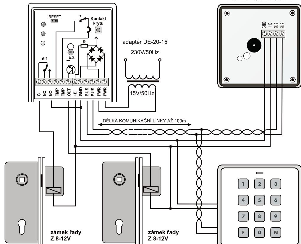
Příklad ovládání dvou dveřních zámků. Stejně zapojení platí pro napájení stejnosměrným napětím. Délku impulsů na výstupech č.1 a č.2 nastavte 1 až 5 s dle typu zámku. Toto zapojení lze užít též pro ovládání garážových vrat, závor na parkovištích atd.
