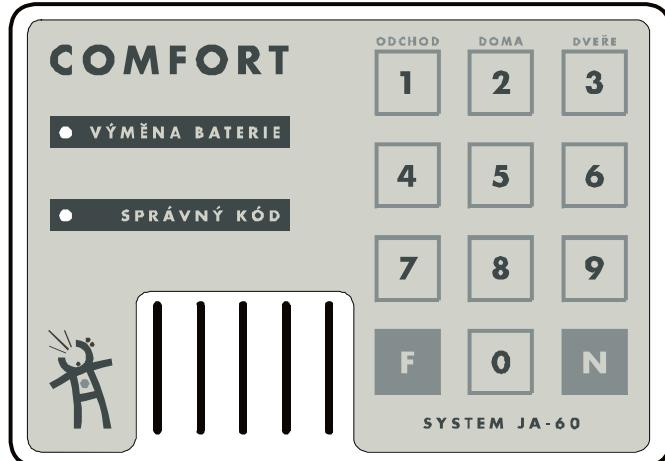
Tato klávesnice je prvkem bezdrátového zabezpečovacího systému JA-60. Umožňuje ovládat systém obdobně, jako klávesnice, která je součástí ústředny. Výhodou je, že tato klávesnice komunikuje s ústřednou bezdrátově a nepotřebuje tedy propojovací kabel. V systému JA-60 je možno použít více ovládacích klávesnic, a lze je kombinovat s dálkovými ovladači RC-11. Ústředna systému je schopna spolupracovat až s osmi ovládacími periferiemi (ovladače + klávesnice).
