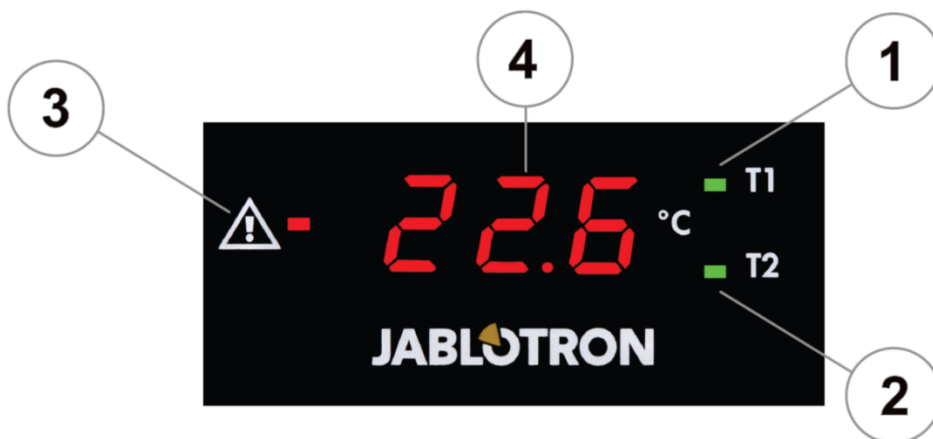
Obr. 4: popis displeja: 1 - LED 1 (indikuje stav snímača T1); 2 - LED 2 (indikuje stav snímača T2); 3 - LED 3 (výstraha / zopnutie / rozopnutie pri negácii / relé); 4 – Displej
