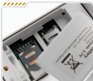
Pod krytom nájdete Li-Ion batériu, slot pre SIM a pamäťovú microSD kartu
