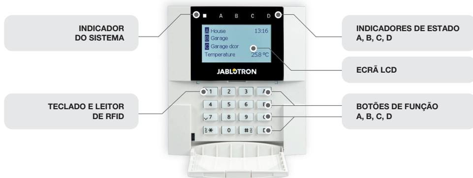
Os estados de secções individuais são indicados pelos indicadores de estado A, B, C e D na parte superior do ecrã LCD e pelos botões de função. A central de alarme permite ser controlada diretamente (armar ou desarmar alarmes e outras funções de automação) utilizando os botões de função do teclado. Os botões de função e os indicadores de estado A, B, C e D apresentam retroiluminação colorida para indicar inequivocamente os estados das secções.
