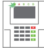
**3. La commande est exécutée** et le clavier signale par voie acoustique la temporisation de sortie. La section est maintenant armée, seuls les détecteurs avec une réaction « Zone temporisée » donnent le temps de quitter la zone protégée pendant la temporisation de sortie. L'indicateur d'état et la touche fonctionnelle de la section armée passent au rouge.
