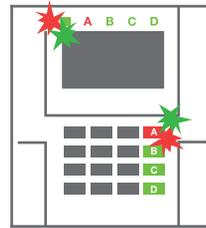
**3. Le désarmement se termine** et les sirènes sont réduites au silence. Les touches fonctionnelles, clignotant rapidement et alternativement (vert / rouge), et les indicateurs d'état signalent la mémoire d'alarme.
