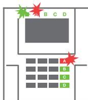
**1. En entrant dans le bâtiment** (déclenchement d'un détecteur avec une réaction « Zone temporisée »), le système commence à signaler la temporisation d'entrée par une tonalité continue, le voyant du système et la touche fonctionnelle, les
