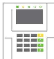
**3. La commande est exécutée** et la touche fonctionnelle passe au jaune en continu pour signaler l'armement partiel de la section.
