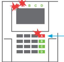
**2. Enclencher la touche fonctionnelle** de la section dans laquelle l'alarme a été déclenchée.
